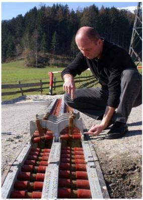
Inserire il Nordic Slider capovolto nella scanalatura.
